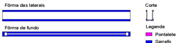
Figura 2: Fabricação de fôrma de viga interna (compensado)
